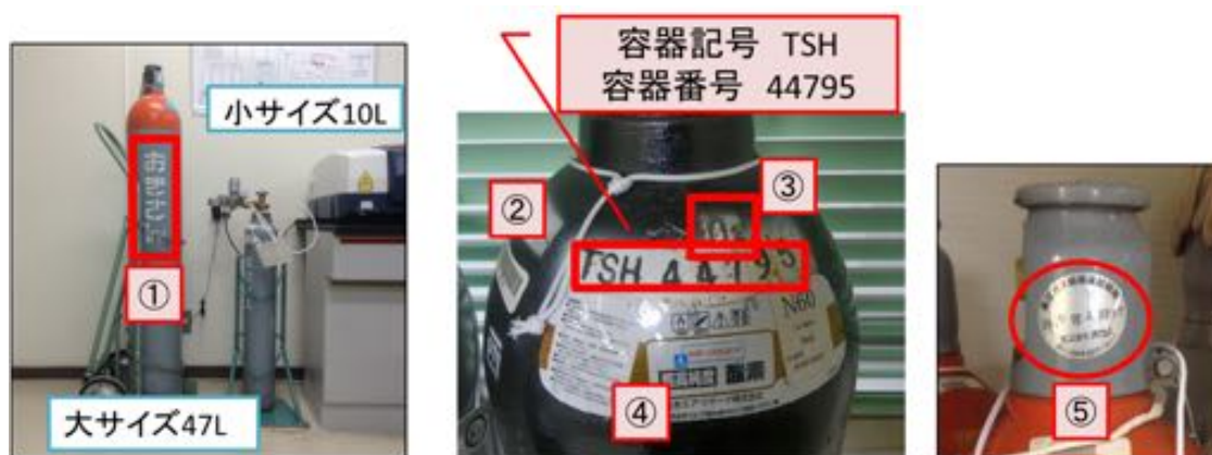
図 I. 3. 3 ボンベのサイズと刻印，ラベル
