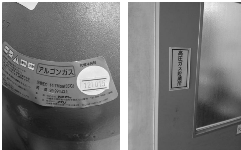
図Ⅲ. 1. 11 使用するガスの種類と表示
