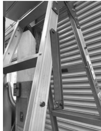
開き止めが閉まっていない
