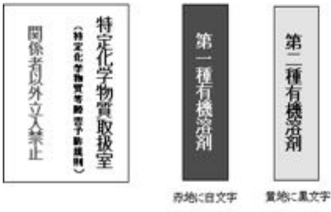
図 I. 6. 1 5 特定化学物質取扱室入口の掲示
